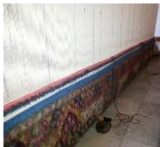
شکل ۵: مشخص کردن عرض و طول قالی جهت آماده سازی برای بافت
